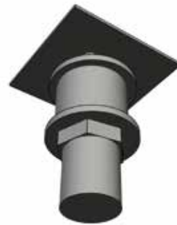
그림 5. 진동 감쇠 가항 고무 적용 위치 예시
