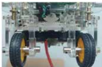
그림 2. 자주차 조향장치 구조
