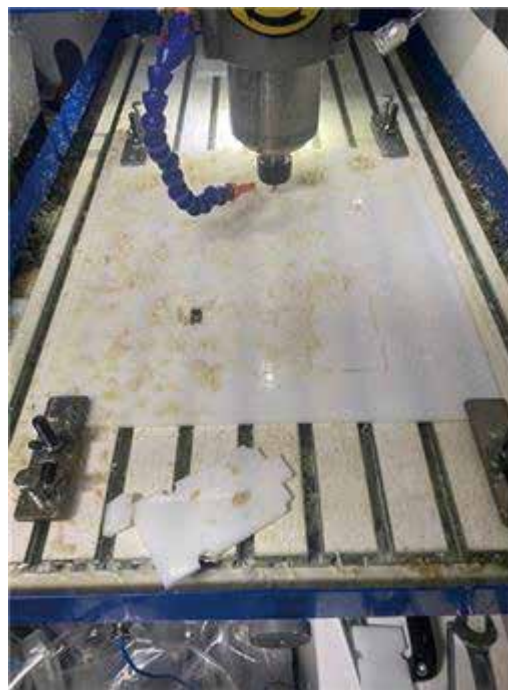
그림 16. JAJUCHA frame CNC milling
