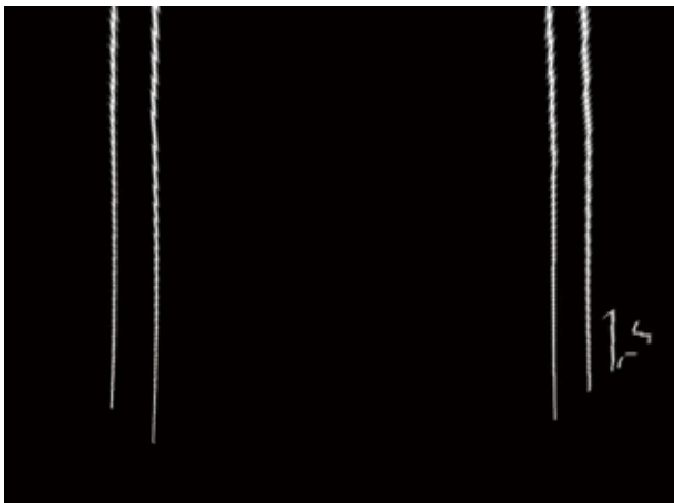
그림 2. Canny Image로 변형 Figure 2. Transform to Canny Image
