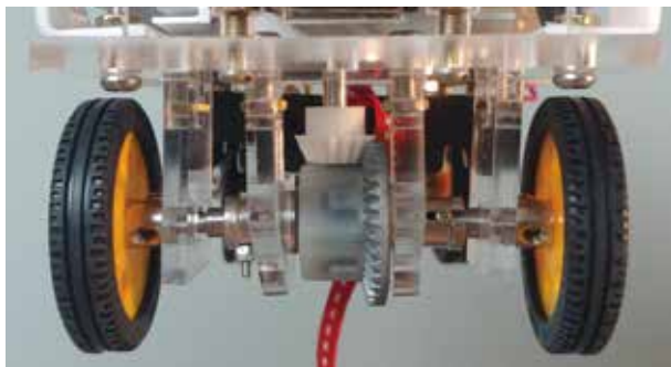
그림 12. 개선 차량 하부에 도입된 차동 장치. 구동 모터에 3d 프린팅 베벨기어(그림 11의 ⑥)를 장착하여 차동 기어의 베벨기어(그림 11의 ②)와 맞물리도록 하였다.
