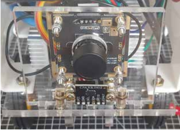
그림 14. 후방 카메라와 거리 센서
