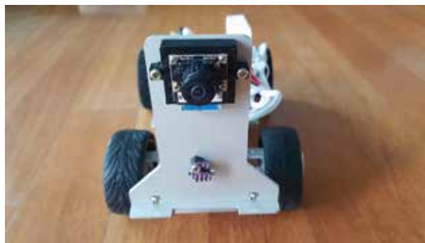
그림 1. 2019년형 자율차의 카메라와 라이다 센서
