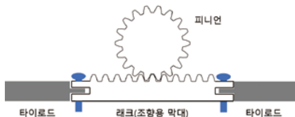
그림 5. 조향부의 랙 앤 피니언 구조. 랙(조향용 막대)와 타이로드를 결합할 때에는 요철 구조에 볼트를 끼워 넣는 방식으로 관절을 만들었다.
