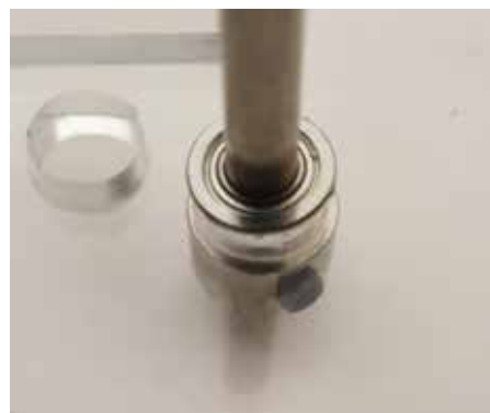
그림 6. 베어링 삽입 사진
